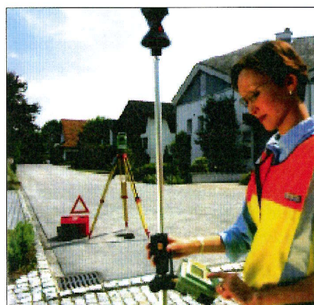
Figure 472. Le porte-prisme consulte en permanence son affichage qui tend vers zéro. © Leica
